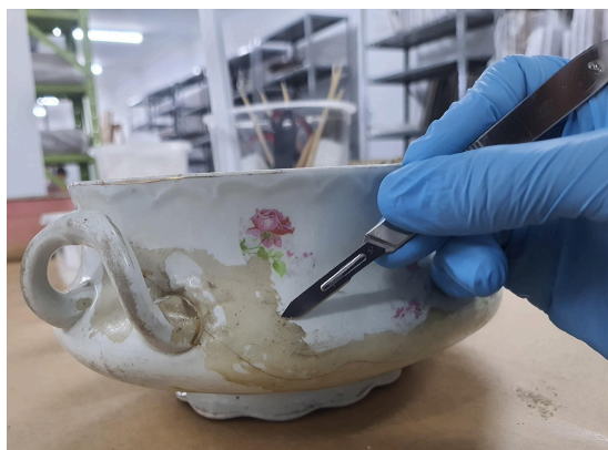
Figura 02: Remoção mecânica de adesivo na parte externa do objeto. Autor: Matheus Santos.
