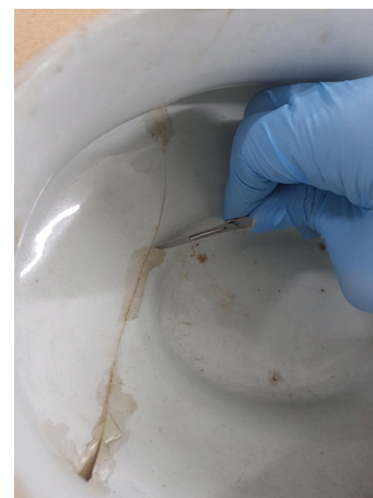
Figura 03: Remoção mecânica de adesivo na parte interna do objeto. Autor: Matheus Santos.
